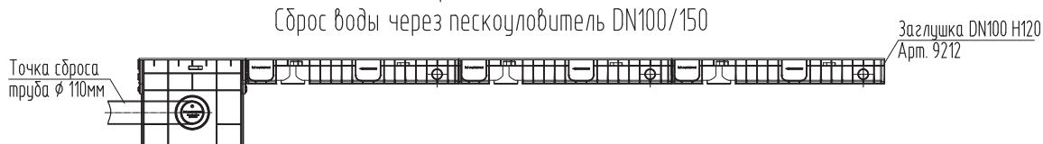
Схема линейного водоотвода при помощи каскадов лотков "AQUASTOK" DN100 H70-H120-H180
