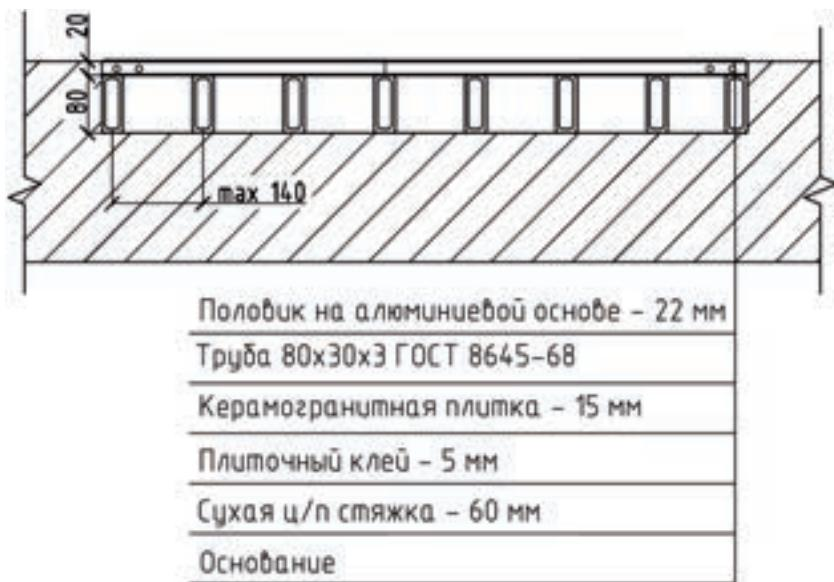
Рис. 18 – Схема монтажа половика в приямок глубиной 100 мм.
