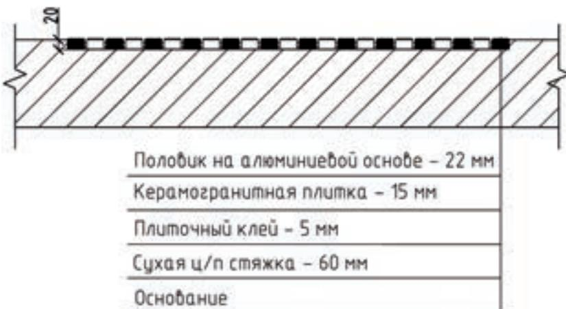
Рис. 19 – Схема монтажа половика в приямок глубиной 20мм.
