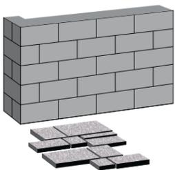
Перед началом укладки камня на стену, обязательно разложите на горизонтальной поверхности камень не менее, чем из 5-ти коробок, чередуя крупные и мелкие элементы, а также камни различных оттенков. Это позволит получить максимально естественный рисунок кладки и ускорит процесс монтажа.
