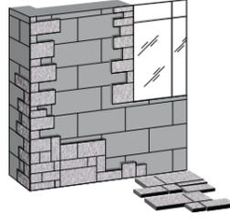
В первую очередь укладываются декоративные элементы (обрамления окон и дверей, русты, карнизы и пр.). Угловые элементы следует укладывать, чередуя длинные и короткие стороны. Затем камень укладывается по направлению от внешних углов и проемов (окна и двери) в сторону ровных стен.
