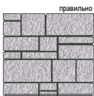
При всех способах укладки избегайте длинных вертикальных швов. При укладке с расшивкой соблюдайте рекомендуемую ширину шва между камнями.
