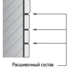
При укладке камня без расшивки, старайтесь подогнать плитки как можно плотнее друг к другу. При этом допускаются как горизонтальные, так и вертикальные зазоры, которые впоследствии по желанию заполняются расшивочным составом для герметизации кладки и улучшения внешнего вида облицованной поверхности.
