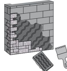
Используйте клей для укладки натурального и искусственного камня (например, клей ИДЕАЛЬНЫЙ КАМЕНЬ®). Сделайте раствор, следуя инструкциям производителя. Нанесите гладким шпателем клеевой раствор на подготовленную стену, толщиной слоя примерно 0,5 см. Разровняйте клей зубчатым шпателем (рекомендуемая высота зубцов 4-6 мм). Нанесите такой же слой клея на тыльную сторону камня. Вибрирующим движением плотно вдавите плитку в клеящую массу.
