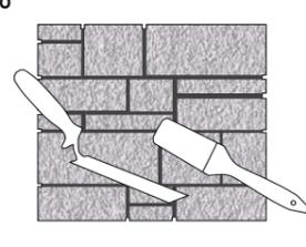
После того, как расшивочный состав слегка схватится, шпателем для расшивки выдавливающими движениями разгладьте швы и удалите излишки раствора. Затем жесткой щеткой (не металлической!) или кистью окончательно зачистите поверхность.
